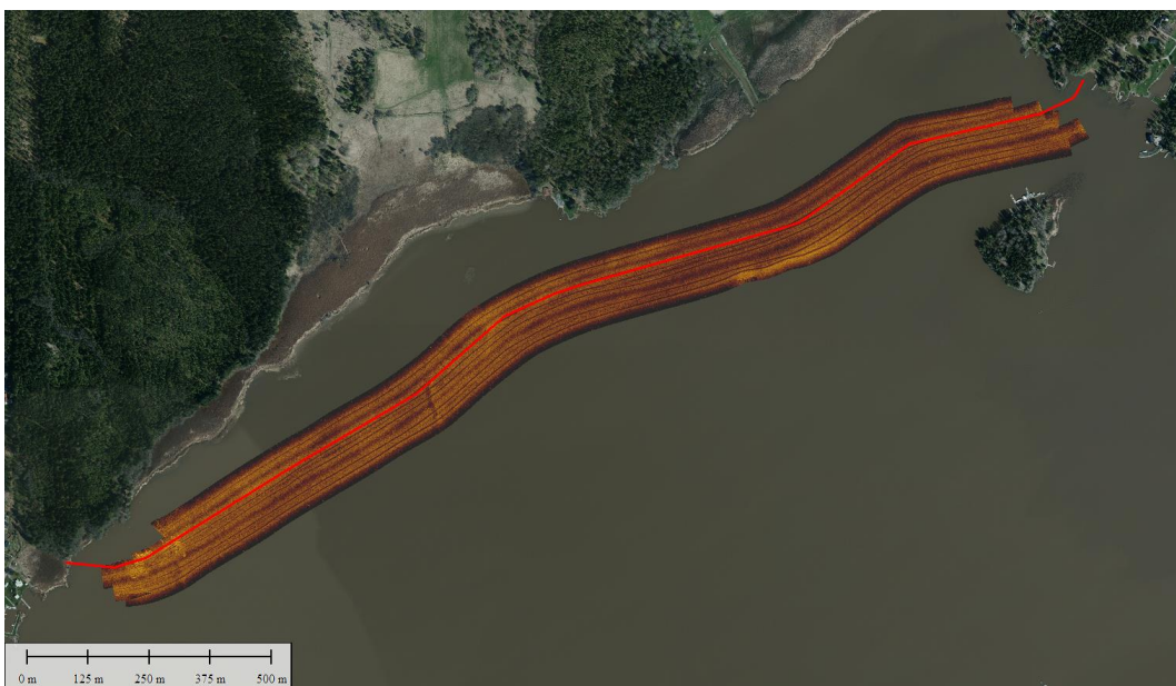
Figur 10 Side-scan sonarbild av botten i område 3. Röd linje visar föreslagen ledningsträckning.
